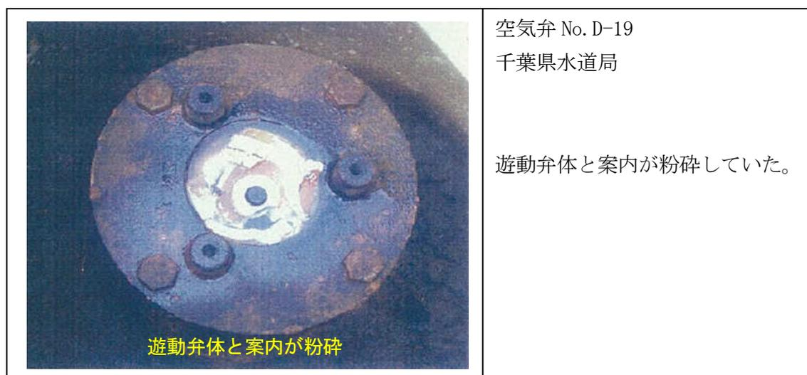
図 3.2.9 D-19(φ100mm 急速空気弁)の被害概要
