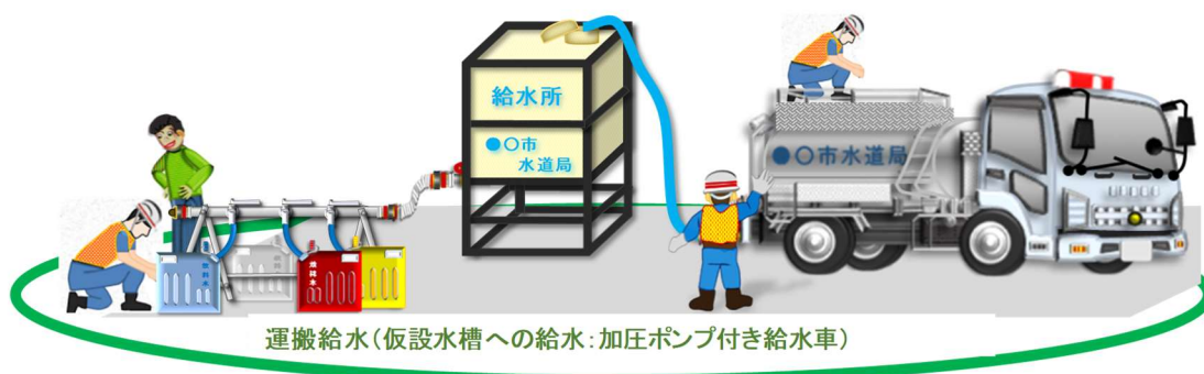
図1-2 仮設水槽による給水
