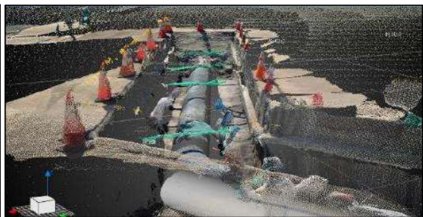
管路を点群化し3Dモデリングを行い、仮想空間上にバーチャルシズオカ（地上点群データ）と同時展開した画像
