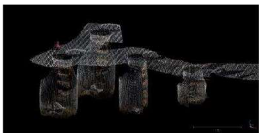
マンホール内を点群化した画像
