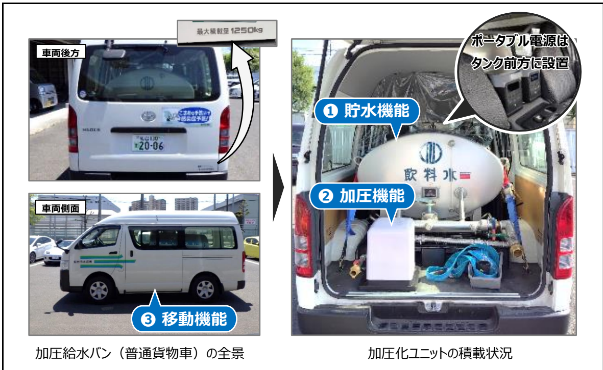
図6 加圧式給水車を代替する加圧給水バン
