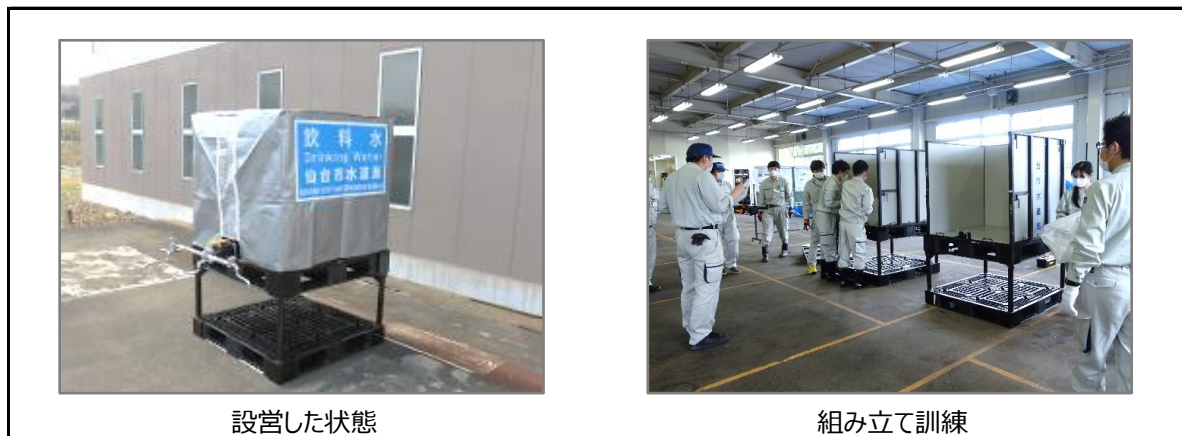
図3 応急給水所に据え置く組立式の仮設水槽
