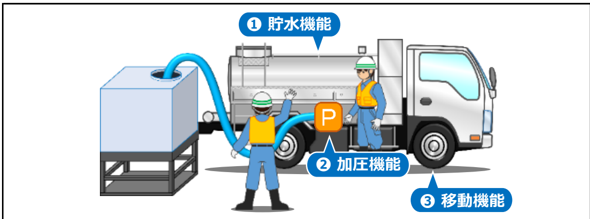
図5 加圧式給水車による仮設水槽への補給方法
