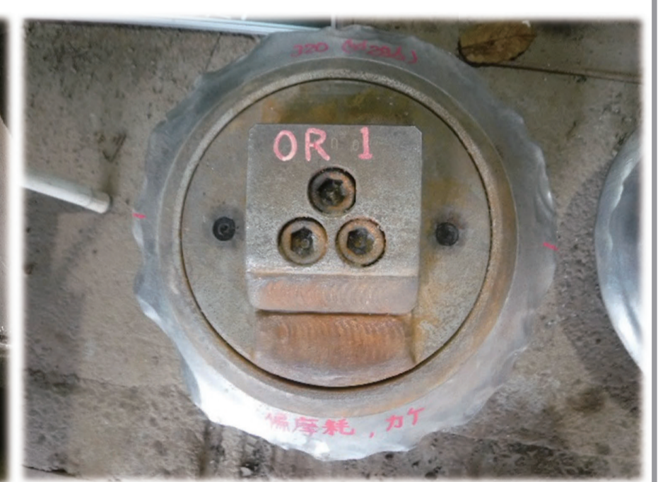
摩耗したビット
