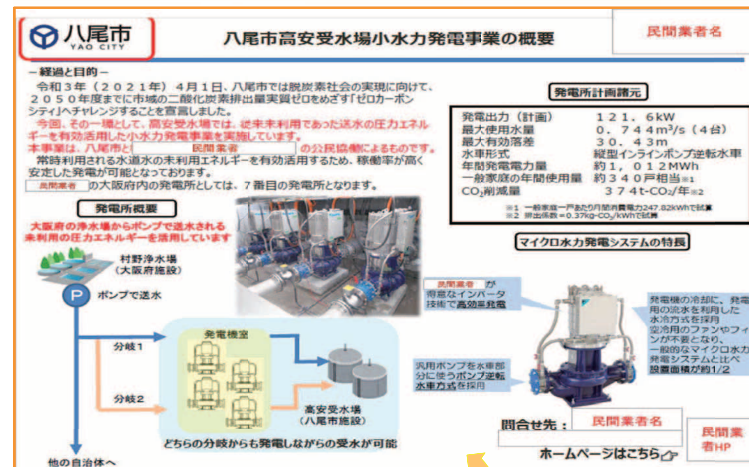
小水力発電システムの概要
