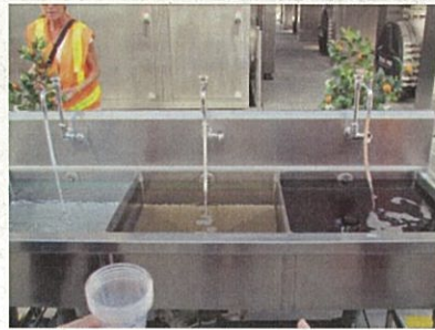
左：高度処理水 右：MF膜の逆洗後の水 中：高度処理施設への流入水
