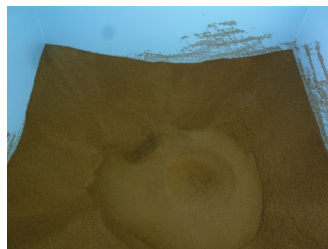
<結晶化した炭酸カルシウム> 定期的にリアクターから抜き取り新しい砂と交換している。鶏のえさや滑り止め等に再利用している。
