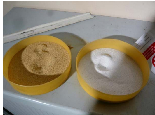
<軟化処理で使用了したペレット> 左：使用後 右：使用前
