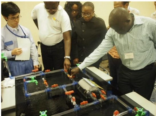
配水模型を用いた配水管理の実習
