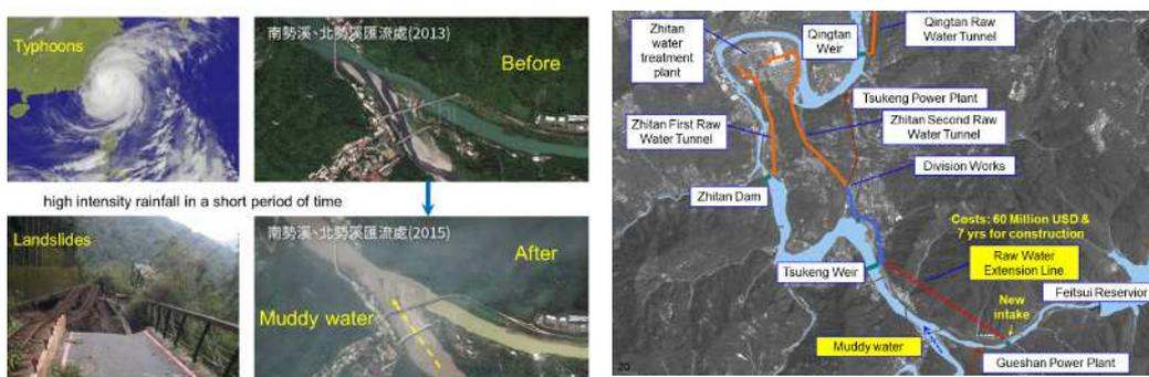
図 15 Feitui 導水トンネルの建設
