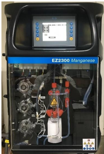
図 22. マンガン監視装置
