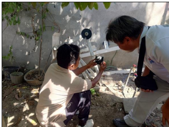
配水管整備後に水質を確認する様子
