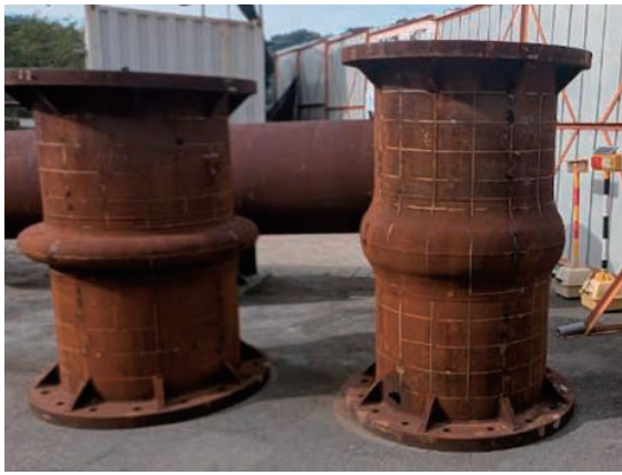
断層用鋼管①
