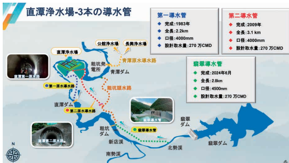
図-10 浄水場の導水管の概要
