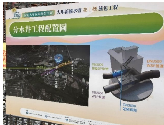
写真2.5.6 φ3500mmをφ2600mm（豊原浄水場導水管）とφ3000mm（鯉魚潭浄水場連絡管）に分水する
