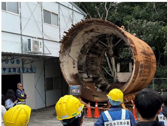
写真2.5.2 実際に使用した掘削機（φ3730mm）
