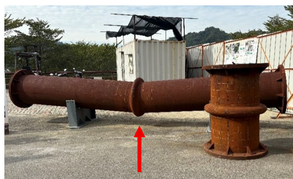
写真2.3.1 座屈波形部（矢印部）を有するSPF
