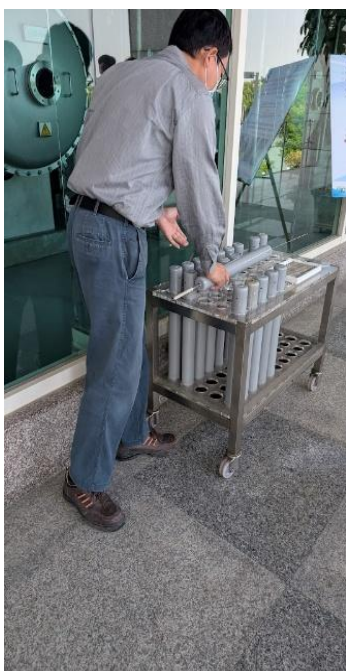
写真-2 オゾン発生器の誘導体
