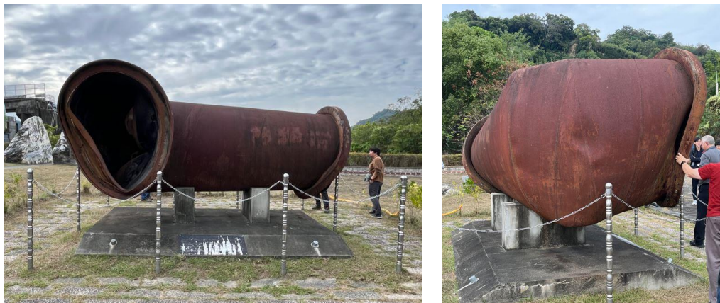
図 17. 大口径管のねじれ破壊
